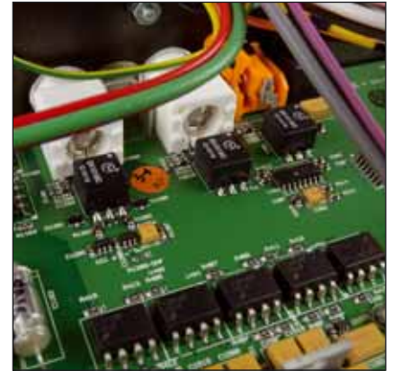
Alle Eingänge sind galvanisch entkoppelt – das macht man so, wenn's richtig werden soll
